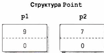
Рис. 2. Присваивание копирует экземпляр типа значения
