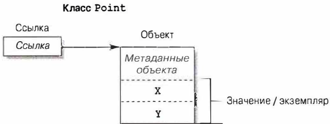
Рис. 3. Экземпляр ссылочного типа в памяти
