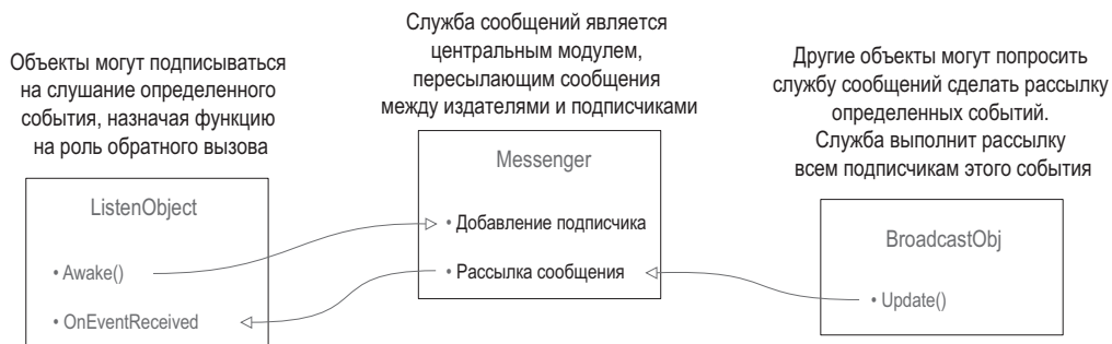
Рис. 7.17. Схема широковещательной рассылки сообщений
