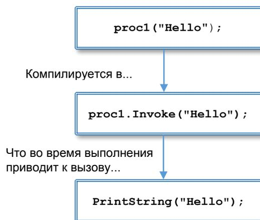
**Рис. 2.1.** Обработка вызова экземпляра делегата, который использует сокращенный синтаксис C#
