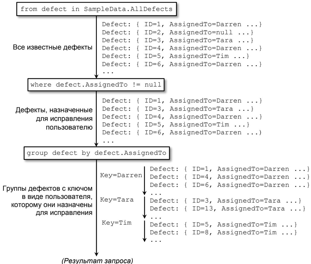
**Рис. 11.9.** Последовательности, используемые при группировании дефектов по назначенному исполнителю. Каждая запись результата имеет свойство `Key` и также содержит последовательность записей о дефектах
