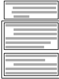
Рис. 14-1. Если код хорошо организован в группы, то рамки вокруг взаимосвязанных разделов не перекрываются; они могут быть вложенными
